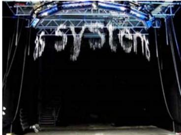
Die einzelnen Düsen werden pc-gesteuert geöffnet, so dass Bilder, Schriften und Informationen in Form von fallendem Wasser entstehen.
